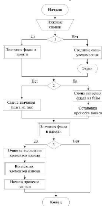
Блок-схема алгоритма захвата видео потока с использованием программного модуля «Video Stream»
