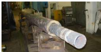
Рис. 1. Биметаллический электрод ЭШП из двух марок стали 25Х1МФ и 38Х2Н2МА
