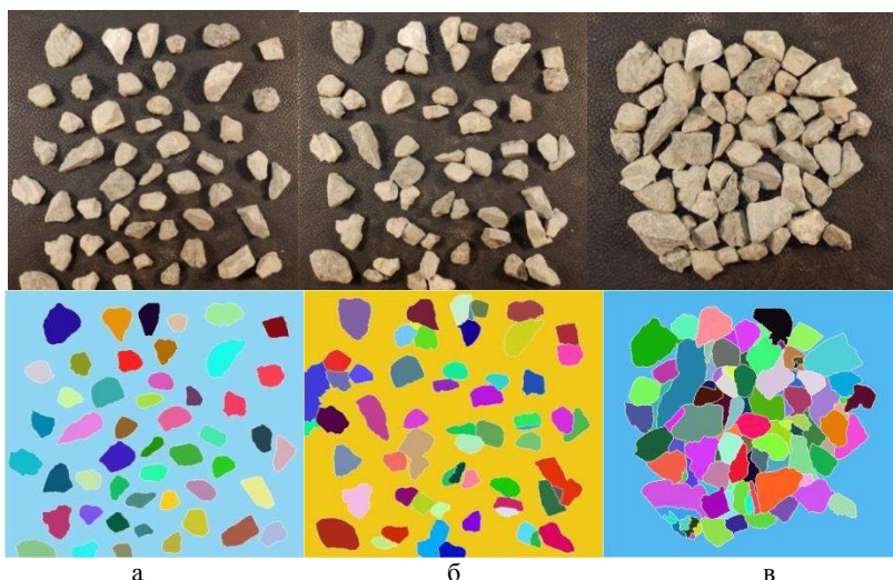
Рис. 3. Определение контуров на изображении зерен, расположенных: а – по отдельности; б – группами; в – слоем
