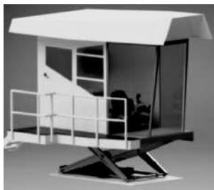
Рис. 1. Моделирование в программном комплексе Autodesk Inventor механизма рычажного типа с модульной кабиной
