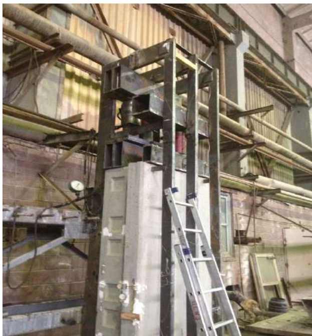
Рис. 1. Общий вид загрузки панели при испытании на срез оболочки
