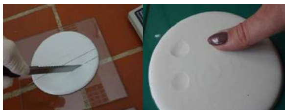
Рис. 2. Определение сроков схватывания по DIN 1168-2-1975 (часть 2)
