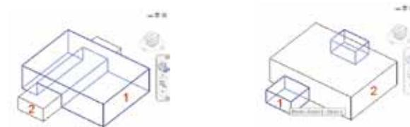
Рис. 15а; Рис. 15в. Влияние очередности выделения элементов на результат вырезания
