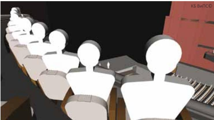
Рис. 13. Проверка вида на сцену с различных зрительских мест
