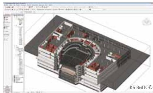
Рис. 7. Один из рабочих моментов моделирования здания в программе Revit Architecture
