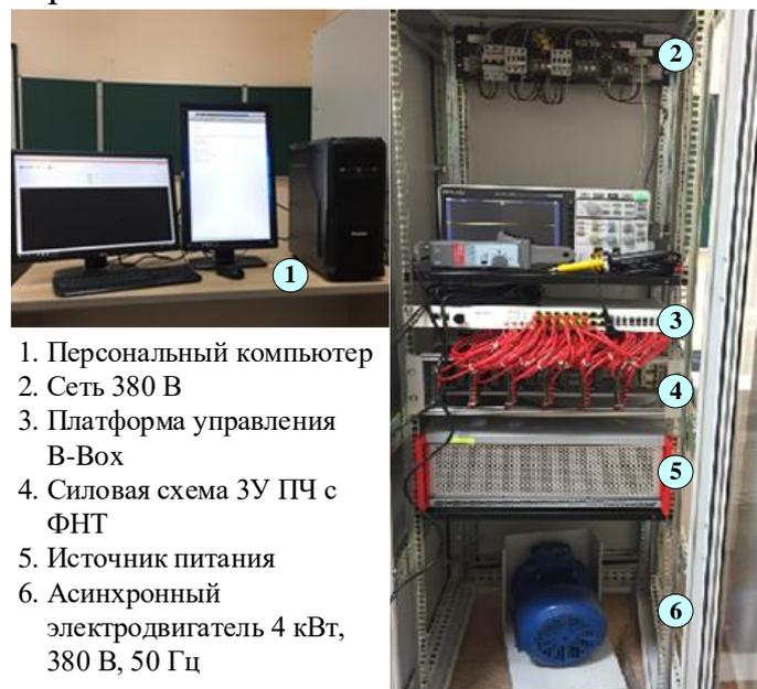
Рисунок 11 – Общий вид экспериментального стенда
