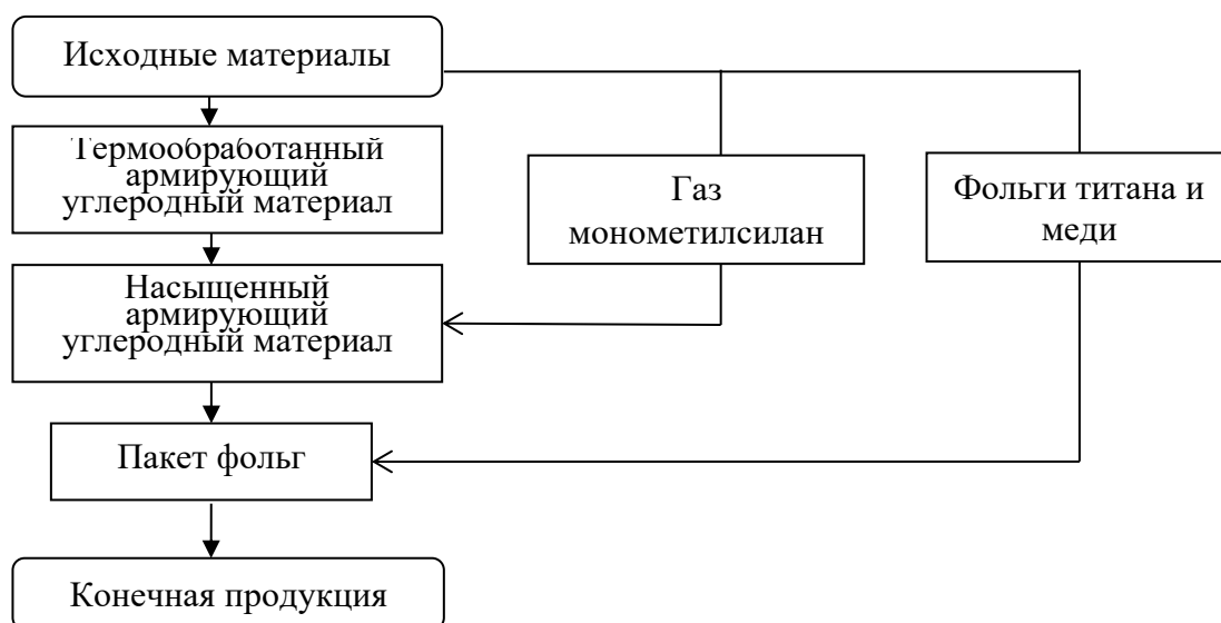
Рисунок 6 – Блок-схема потока веществ при изготовлении металломатричного слоистого композиционного материала [91, 92]
