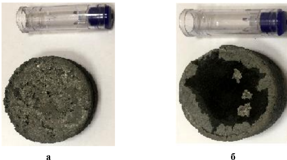
Рисунок 27 – Внешний вид образца, полученного после насыщения расплавом титанового сплава ВТ-14 [109]
