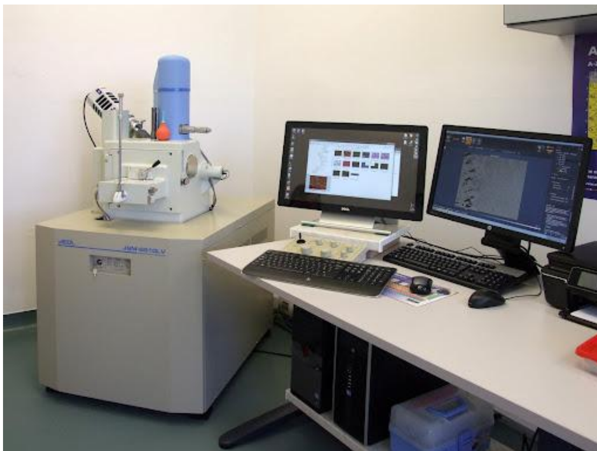
Рисунок 29 – Сканирующий электронный микроскоп (JSM-6610 LV с энергодисперсионным анализатором Advanced AZtec
