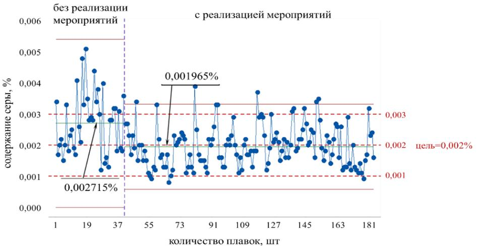
Рисунок 7 – Сравнение результатов работы по традиционной технологии и после оптимизации технологического режима десульфурации
