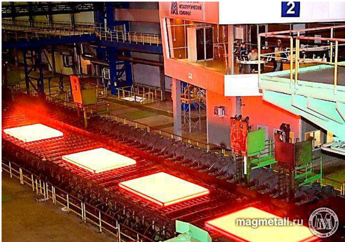
Рисунок 1.5 – Вид на прокатную клетку со стороны печей (а) и одновременная прокатка шести раскатов (б)
