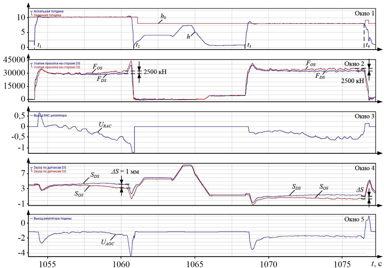
Рисунок 5.11 – Осциллограммы, аналогичные рис. 5.6, при внедрении разработанного способа и ПД регулятора перекоса зазора валков
