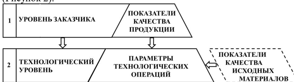
Рисунок 2 – Иерархически организованная информационная подсистема получения продукции из композиционных материалов
