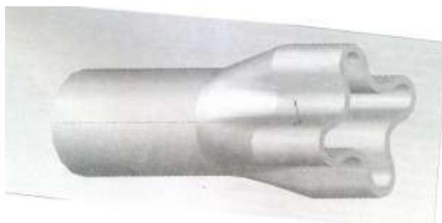
Рис. 2. Общий вид конструкции сопла (вставки-«картриджа») наконечника кислородной фурмы
