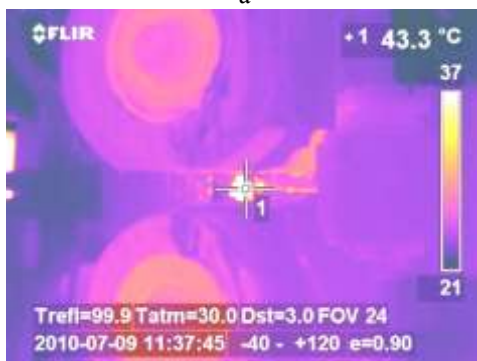
Рис. 4. Измерение температуры роликов после прохождения полосы между роликов валковой арматуры (а) и перед прохождением полосы между роликами валковой арматуры (б)
