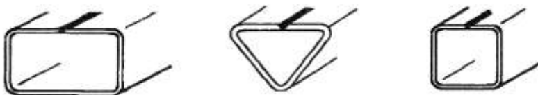
Рис. 1. Примеры конфигурации поперечного сечения профильных труб
