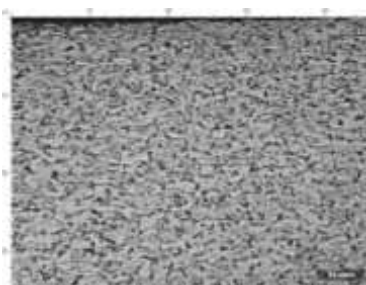
Рис. 3. Микроструктура поверхностных слоёв стальной ленты после плазменно-электролитной обработки, x500
