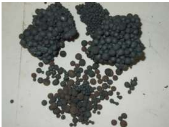
Рис. 2. Образец гибридного агломерата, полученный в лабораторных условиях
