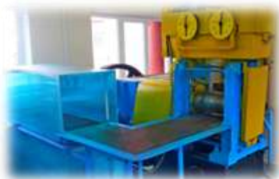
Рис. 5. Реверсивный прокатный стан, совмещенный с установкой контролируемого охлаждения
