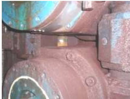
Рис. 3. Расположение роликов валковой арматуры при замере их температуры во время прокатки
