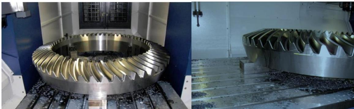
Рис. 5. Изготовление конического колеса с круговым зубом в условиях производства
