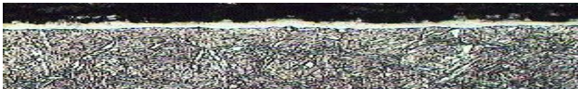
Белый слой твердого карбонитрида на поверхности детали
