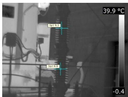
Рис. 3. Термограмма ОПН АПК-1
