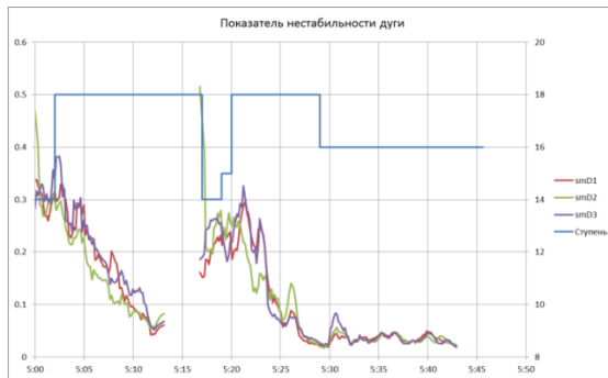
Рис. 3. Изменение показателя нестабильности дуги и ступеней напряжения по ходу плавки
