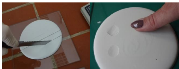
Рис. 2. Определение сроков схватывания по DIN 1168-2-1975 (часть 2)
