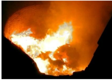
Рис. 2. Вид ванны ДСП-135 приблизительно в середине расплавления завалки. Видны зоны действия фурм, где расплавление опережает расплавление в зоне действия дуг
